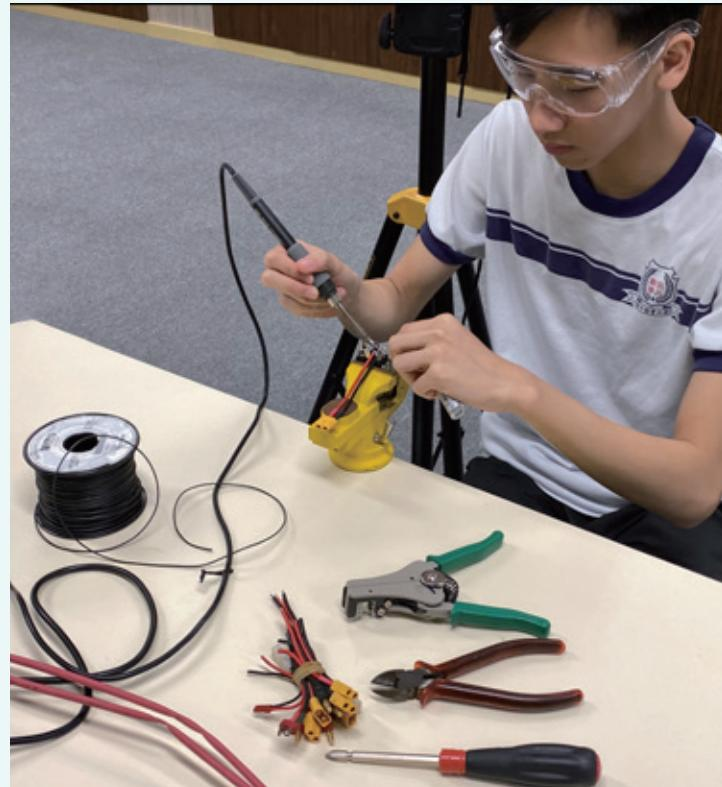
同學製作機械人時焊接電線。
